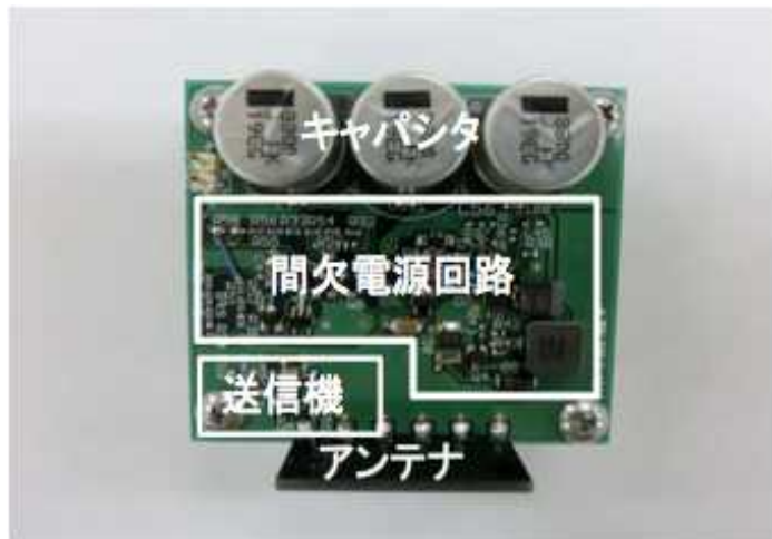
図4 植物発電センサーボード
