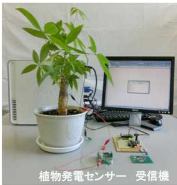
図1 植物発電による植物モニタリングシステム
